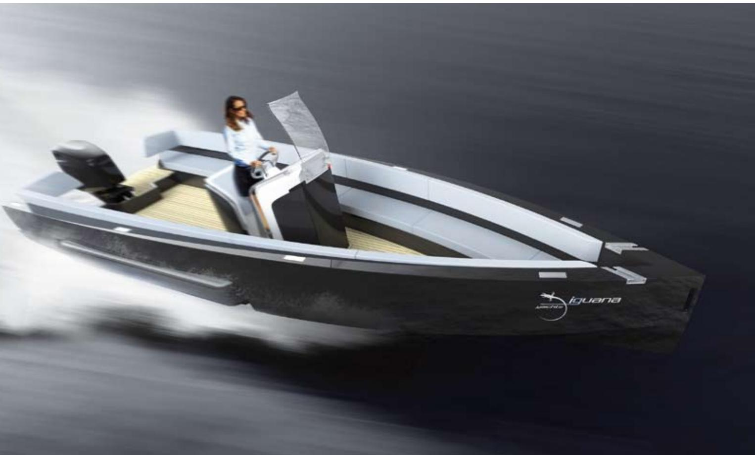
L'Iguana 29 déjauge rapidement pour atteindre des vitesses de plus de 30 noeuds. Sa carène perce-vague au «V» acérée passe dans les mers formées avec aisance. Très stable en virage, c'est un bateau marin et ludique.
